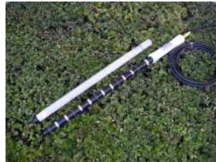
上:アクセスチューブ 下:プロファイル土壌水分センサ
