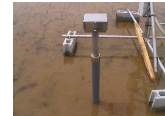
水田用水位計 UIZ-WLR100-LR (別紙カタログをご参照下さい。)
