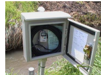
データロガー収納例(写真は UIZ3635) (データロガー収納ボックス オプション)
